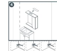
Ако шкафът има осветление и контакт, захранването е свързано и е затворено с пластмасов капак. If there is a light and a plug, the wire connection is done and covered by the plastic protection panel. Wenn es bei den Spiegelschränken einen Beleuchtung gibt, wird dies mit einem Plastik Deckel zugedeckt.
