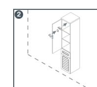
Окачвачите се монтират в корпуса. Колонният шкаф се поставя върху нивелиращия L профил, след което се фиксира към стена. Hanging equipment is fixed on the body of the side cabinet. The side cabinet is placed onto the adjusted L profile and then should be fixed to the wall. Seitenschrank wird mit dem Hilfe von der L Profile an den Wand aufgehängt.
