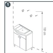
Пробиват се отвори за окачвачи, за горния шкаф, с диаметър 8 mm. Upper unit hanging part holes will be inserted with 8 mm nails according to hanging height. Die Halterungen der Spiegelschränke wird an der Wand mit dem 8mm Nagel Bohrungen angehangt.
