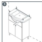
Плътът от керамика, стъкло или мрамор, се поставя върху нивелиращия корпус, след което при необходимост крачета се регулира допълнително с винтовете. Керамичните мивки трябва да се фиксират към стената с монтажна арматура. Ceramic, glass or marble bench is put on the adjusted unit. End position is adjusted once again with screws under the feet if it is necessary.
