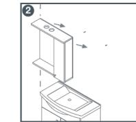
Окачвачите се фиксираят към стената с пластмасови дюбели. Plastic dowels and hanging parts will be fixed to the wall. Kunststoffdübel und hangenden Teile werden an der Wand befestigt.
