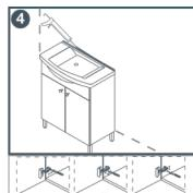
Плътът се фиксира към стената със силикон и в продължение на 24 часа не трябва да се мести и мокри.
