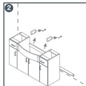
Окачвачите се монтират върху корпуса, след което долният шкаф се поставя върху L профила, който е нивелиран предварително и се фиксира към стена.
