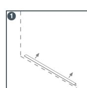
Крачетата се монтират с винтове 3,5x20. The feet are monted with 3,5x20 screws to the side cabinet. Die Füße sind mit 3,5x20 Schrauben an der Seite Schaltschrank montiert. "По данни от тестове се монтира L профил." "Due to test results, L profile is used." "Laut Testberichten werden beim Schranken L Profil benutzt."
